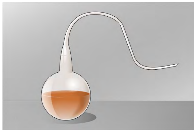
Figura 1. Matraz de cuello de ganso, inventada por Pasteur para demostrar la inexistencia de la generación espontánea.
